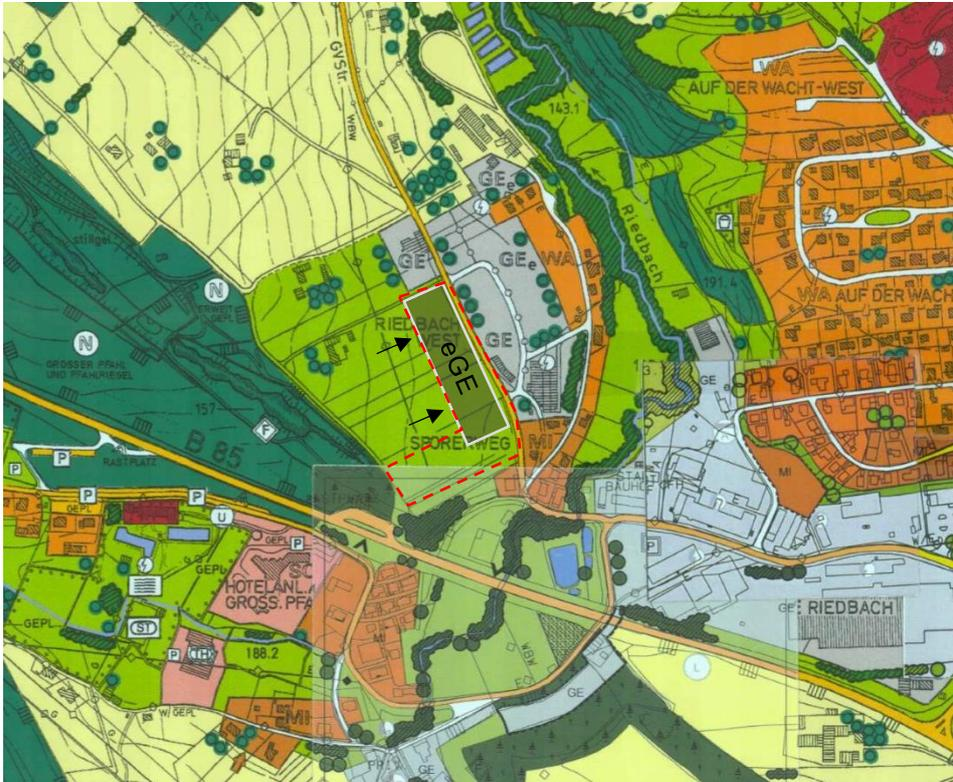
Abbildung 6: Auszug aus dem Flächennutzungsplan mit integriertem Landschaftsplan der Stadt Viachtach mit der Deckblattänderung 13 (dunkle Fläche mit weißer Umrandung = Gewerbegebiet; Pfeile = keine bauliche Erweiterung) und Darstellung des Geltungsbereiches von Deckblatt 4 zum Bebauungsplan (roter Umgriff), 2024 (Quelle: Stadt Viachtach, ergänzt durch brunner architekten; ohne Maßstab)
